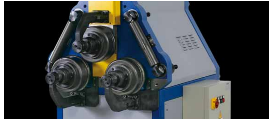
DS 80 equipaggiata con Supporti Indipendenti DS 80 equipped with Independent Supports
